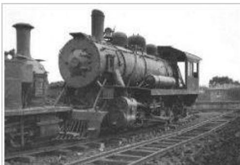
**Figura 9: Locomotora Baldwin que habría sido transformada de cremallera a adherencia.**
